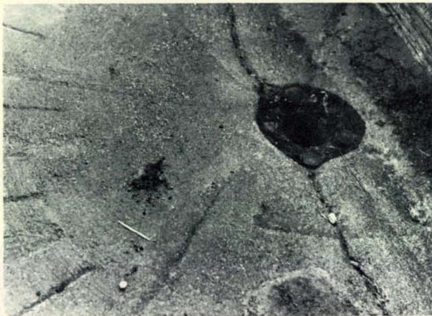
Vista de la boixa (mena de coixinet rudimentari), d'una mola del molí de can Mitjana, suara desmuntat. ◀
