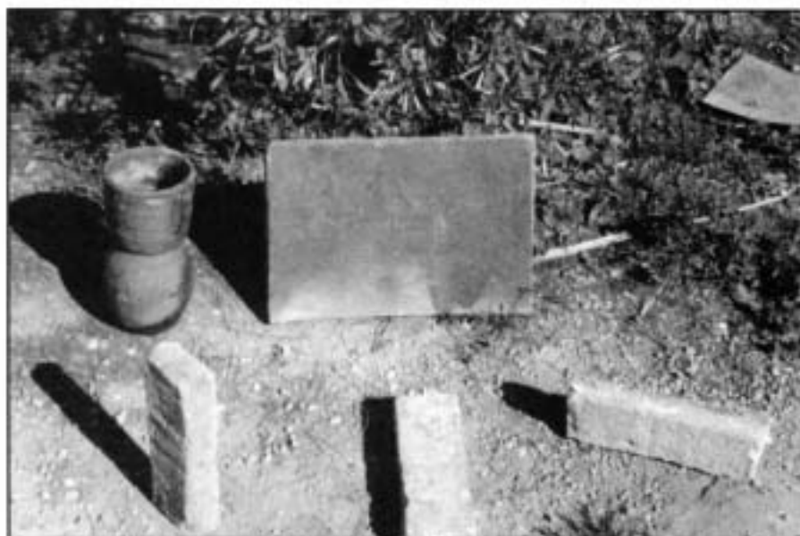
Peces tradicionals de fang que es feien a les bòbiles: catufol, card de cup i maons "pibrolins". Foto: J. Sivill
