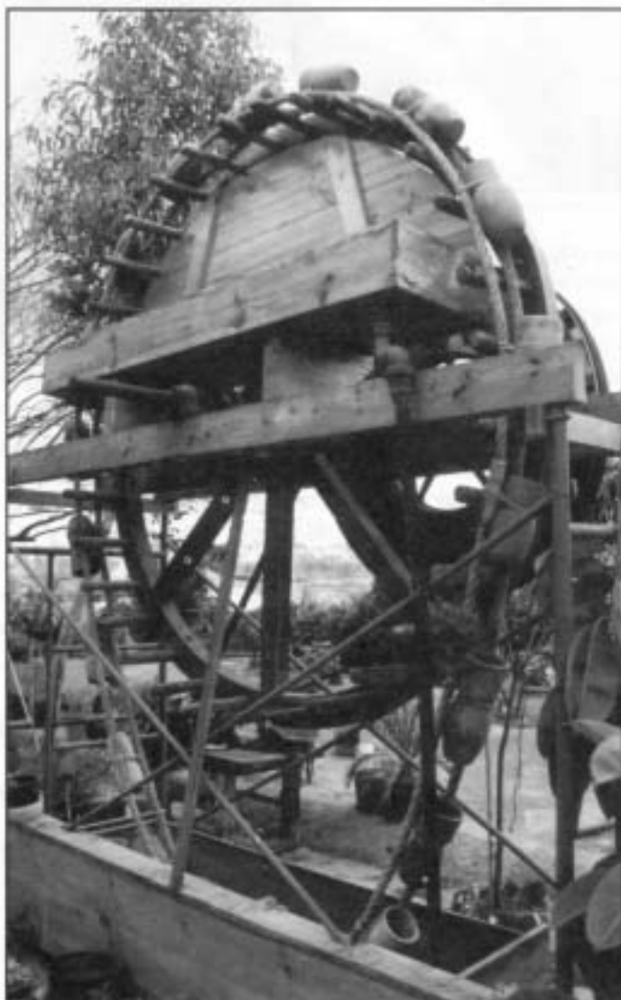
Aspecte general d'una sínia construïda per Francesc Cosp, de la sínia Capador. S'hi pot observar la utilitat de la corda. Foto: Jordi Minella
