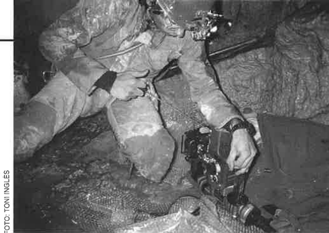
Engegant un trepant percussor amb motor d'explosió.
