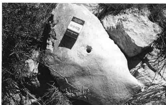
Per fracturar qualsevol bloc primer cal fer un o més forats. Això dependrà de la seva grandària, del diàmetre de la broca i de com volem que es trenqui.
