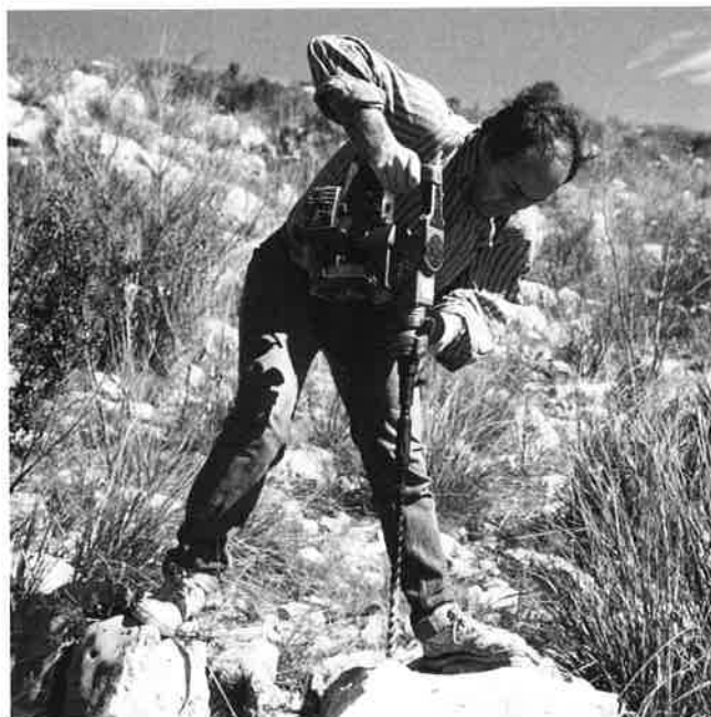
Per fer les perforacions utilitzem un trepant amb motor d'explosió i broques de 50-60 cm de llargada total.
