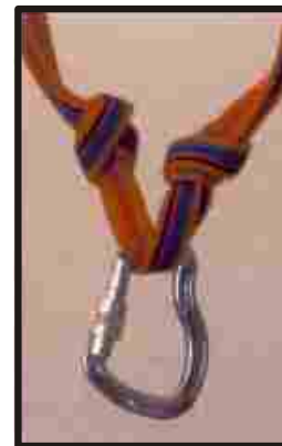
Triangle amb els dos braços semibloquejats. figura 4
