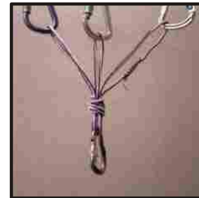
Triangle bloquejat sobre tres ancoratges.
