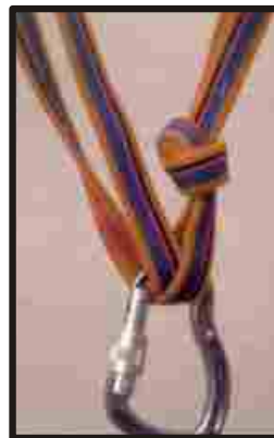
Triangle de dos braços amb un braç semibloquejat. figura 3
